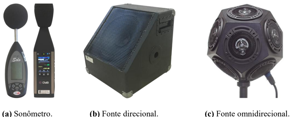
Figura 3: Equipamentos padronizados de emissão sonora e medição utilizados (Fonte: os autores, 2023).
