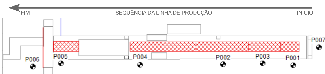
Figura 1: Localização dos pontos de medição próximo ao equipamento - Máquina 01.
